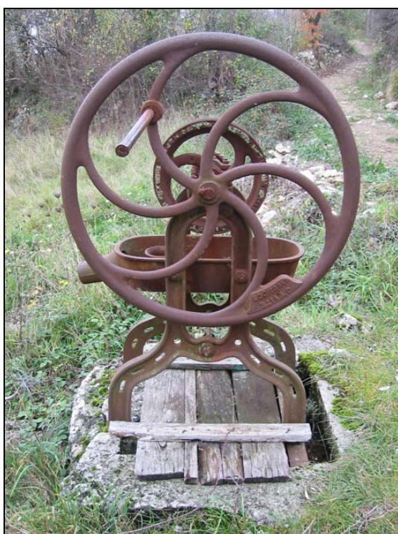
A gauche : pompe métallique installée au-dessus d'un puits, près de la mare de La Vacquerie. – A droite : pompe identique au Mas de Bedos. Les vaches de ce lieu, élevées pour la fabrication de fromages, venaient boire à ce puits. En actionnant la roue, on faisait monter l'eau par des godets en caoutchouc, pour remplir deux bassins en pierre, appelés piles, qui servaient d'abreuvoirs.
