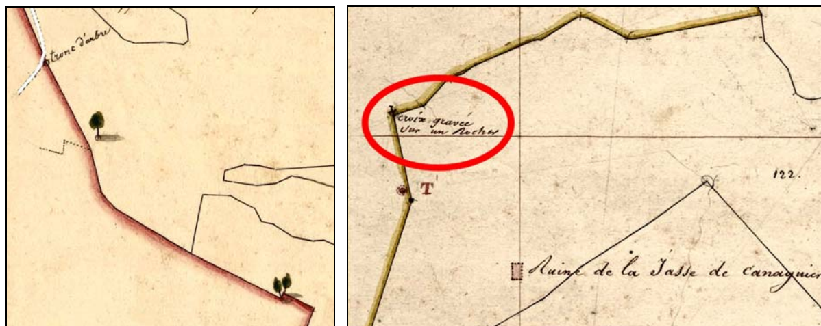
Plan cadastral dressé en 1834 (deux détails). – Les indications de « tronc d'arbre », « croix gravée sur un rocher », et les dessins d'arbres, fixent des points de repère sur le tracé des limites.
